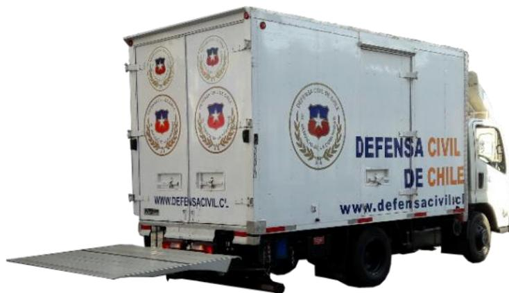
Además, proporciona una mayor estabilidad en cargas diversas, lo que evita la posibilidad de una caída a causa de balanceos. El elemento que brinda tal característica es el sistema hidráulico que integra el equipo, el cual permite que haya movimientos resistentes y precisos; así mismo, garantiza que la carga se mantenga firme al ser elevada con total seguridad. De esta manera, el camión puede transportar cargas sin que la integridad de estas resulte maltratada.
